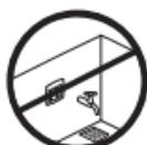
Терморегулятор не можна встановлювати у приміщеннях з високим рівнем вологості. В цьому випадку встановлюйте його у суміжній кімнаті. Встановлювати терморегулятор треба відповідно до місцевих норм щодо IP класів захисту від вологи.
