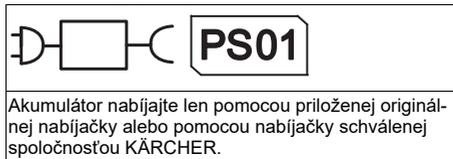
Akumulátor nabíjajte len pomocou priloženej originálnej nabíjačky alebo pomocou nabíjačky schválenej spoločnosťou KÄRCHER.
