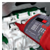
Отвори на лицьовій стороні механізму для контрольного тестування
