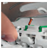
Збільшені затискачі безгвинтових клем
